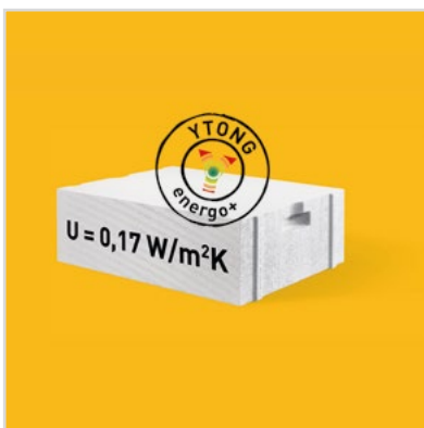
Ytong Energo+. Najcieplejszy materiał dedykowany ścianie jednowarstwowej, który spełnia najwyższe wymagania termiczne przy wytrzymałości na ściskanie 2 N/mm 2 . Grubości: 36,5 i 48 cm. Mury z elementów o grubości 36,5 cm spełniają aktualne normy cieplne dla budynków mieszkalnych bez dodatkowej izolacji. Ytong Energo+ o grubości 48 cm nie wymaga ocieplenia nawet przy budowie domów energooszczędnych, gdzie współczynnik przenikania ciepła U musi być \leq 0,20 [W/(m 2 K)].
