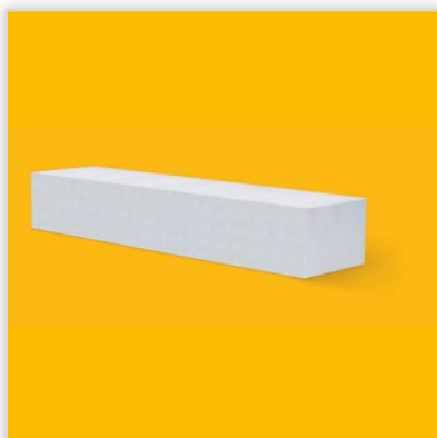
Nadproża Ytong (YN). Wykonane są ze zbrojonego betonu komórkowego, wysokość 24,9 cm. Maksymalna szerokość przekrywanego otworu wynosi 175 cm. Stosowane do otworów okiennych i drzwiowych. Zapewniają odpowiednią izolacyjność cieplną bez dodatkowego ocieplenia. Bardzo łatwe i szybkie w zastosowaniu – montaż nadproża zajmuje dwóm osobom kilka minut.
