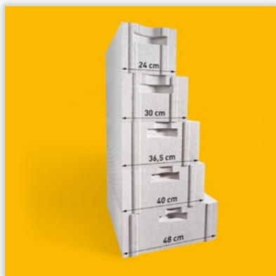
Bloczki Ytong Energo. Bloczki z betonu komórkowego. Zastosowanie: bloczki gr. 30; 36,5; 40; 48 cm – jednowarstwowe ściany konstrukcyjne, bloczki gr. 24 cm – ciepła ściana dwuwarstwowa.
